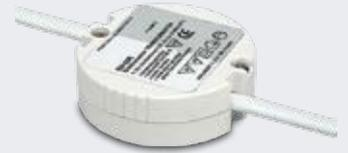
Elektronischer Einbaukonverter für Installationslösungen auf engem Raum, primär und sekundär 15 cm Anschlussleitung mit offenen Kabelenden, dimmbar mit gängigen Phasenabschrittdimmern, 20-60 W, Ø 57 mm, H. 19 mm
