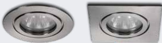
NV-Deckeneinbauleuchte, **V4A Edelstahl**, Glas klar, Deckenausschnitt 68 mm, Einbautiefe 55 mm, für z. B. **5,5 W LED**, MR16, **GU5,3**, 12 V, EEK A+ - C (EEK-Spektrum A++ - E)
