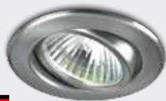
Deckeneinbaustrahler aus hochwertigem **V4A Edelstahl**, schwenkbar 25°, separates Deckenteil des Strahlers ermöglicht Vorinstallation der Leuchte, zum Renovieren wird nur das Vorderteil abgezogen, Deckenausschnitt Ø 68 mm, Einbautiefe 55 mm, Ø 80 mm, für z. B. **8,8 W LED**, MR16, **GU5,3**, 12 V, EEK A+ - C (EEK-Spektrum A++ - E)
